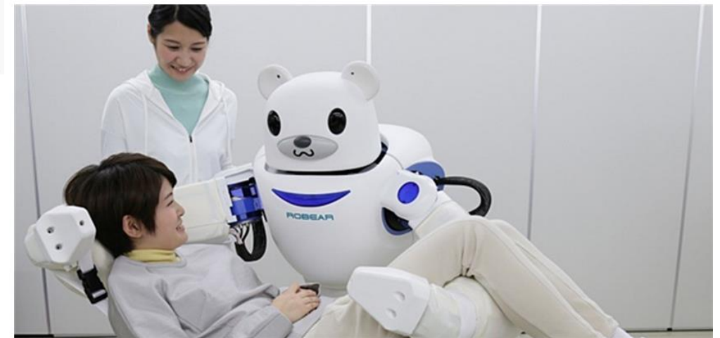
Der Roboter ROBEAR kann Menschen aus dem Bett heben und auf einem Rollstuhl platzieren. © TORU KAWATA / DPA
